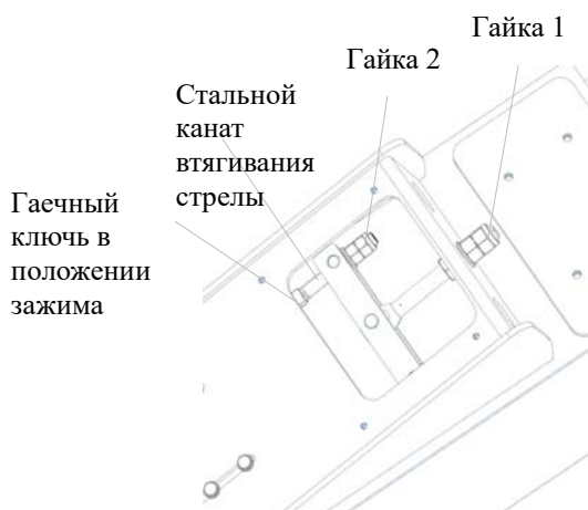
Рис. 5-8. Схема демонтажа гидроцилиндра выдвигания-втягивания 1
