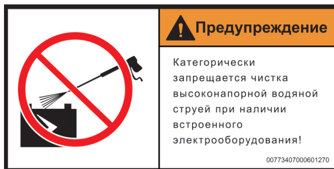
Рис. 1-2. Угроза поражения электрическим током!
