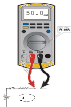
Рис. 7-4 Измерение тока (постоянный ток)
